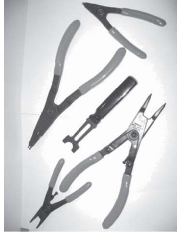
dozownik do montażu płytek osadczych DIN 6799 z opakowań zbiorczych na stalowym pręcie
